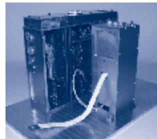
Spektrofotometr rentgenowski SphinX (Solar Photometer IN X-rays). Większy blok to przyrząd lotny do umieszczenia na pokładzie satelity Koronas-Photon.
